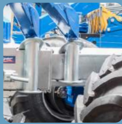
Teleskopierbarer Rahmen, verschiebbar nach der 1. Rungenbank (eingefahren)
