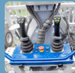
Hydr. Vorsteuerung mit E-Funktion
