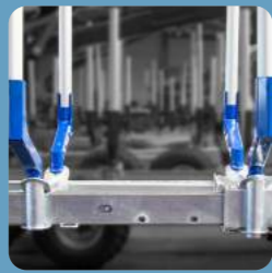
Teleskopierbarer Rahmen, verschiebbar nach der 1. Rungenbank (ausgefahren)
