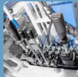
Mech. Kreuzhebelsteuerung mit E-Funktiongeschlossen
