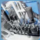
Mech. Kreuzhebelsteuerung mit E-Funktion geschlossen
